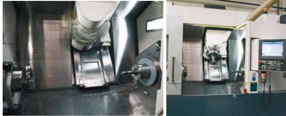
OKUMA MULTUS B 300 15kW ø630 x 900mm 15kW 630 x 230 x 900 mm
